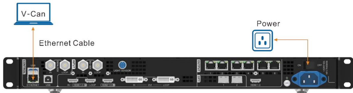
6-1 ábra Hardver csatlakozás
