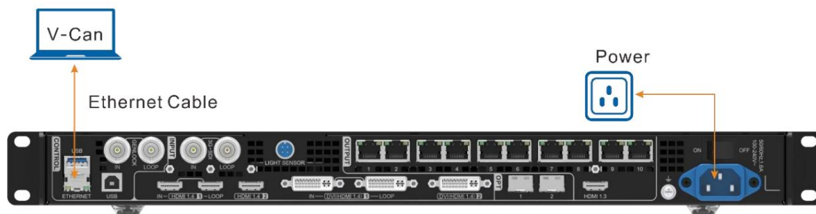
6-1 ábra Hardver csatlakozás
